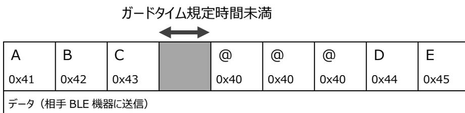
アドバタイズ状態からアドバタイズエスケープ状態に移行する場合もガードタイム経過後に@@@を 3 回連続で送信してください。
